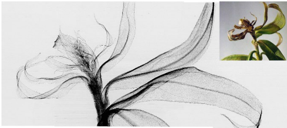
SOIピクセル検出器による花のX線画像
